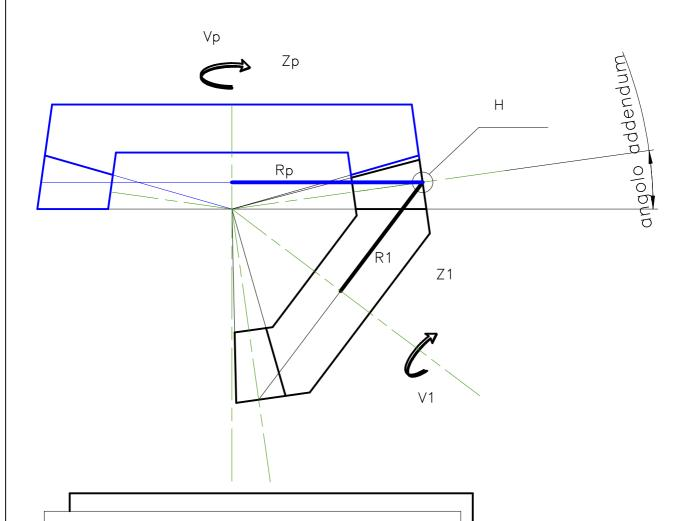
La velocità V delle due ruote: V1\* R1 = Vp\*Rp
